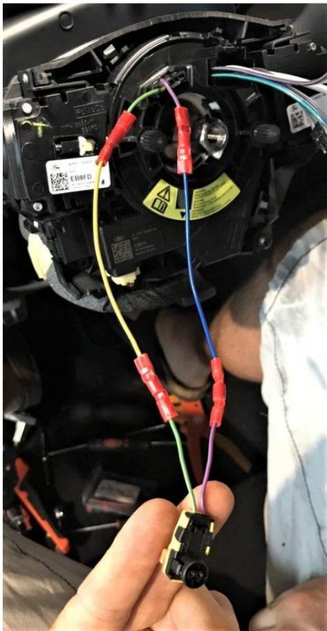
**Nella foto qui a sinistra potete vedere il risultato finale: il cavo airbag prolungato. D'ora in avanti si può procedere a montare il distanziale e il volante.**
